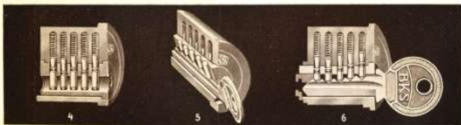
Abb. 4. Innenansicht des Zylinders ohne Schlüssel. Die Stifte liegen ganz verschieden. Sie sperren die Trennungslinie.
