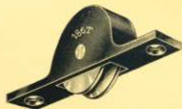
Gehäuse aus Trolit, schwarz poliert, 10 mm dick, mit gehärteter Stahlrolle und konischer Kugellagerung
