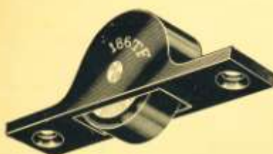
Gehäuse aus Trolit, schwarz poliert, 13 mm dick, mit gehärteter Stahlrolle mit Vulkanfaser umzogen und beiderseitigem Stahlkugellagering
