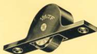
Gehäuse aus Trolit, schwarz poliert, 10 mm dick, mit gehärteter Stahlrolle mit Vulkanfaser umzogen und konischer Kugellagerung
