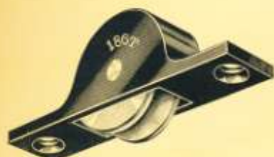
Gehäuse aus Trolit, schwarz poliert, 13 mm dick, mit gehärteter Stahlrolle und beiderseitigem Stahlkugellagering
