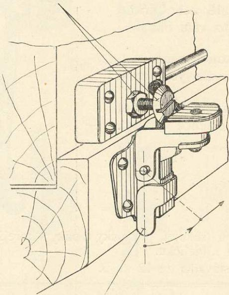
Natočením pojistky a jejím vysunutím je zámeček lehce rozebíratelný a okenní křídlo lze vysaditi.
