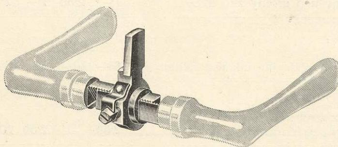
Při demontáži zámku zůstanou oba štíty pevně přišroubované, vyjmě se nejprve šroubek A v čele zámku, pak se hlavní šroub v ořechu uvolní, načež se obě kliky vysunou; zámek lze bez jakéhokoliv poškození dveří a nátěru vyjmouti.
