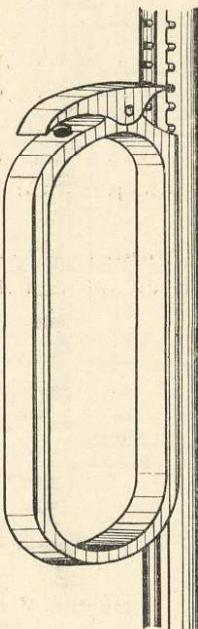
Okenní křídlo i v libovolné otevřené poloze lze zajistiti jednoduchým stavěním rukojeti. Rukojeť je na stranu sklopna.
